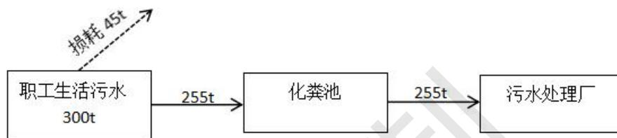
图 2.5-1 本项目水平衡图（单位：t/a）
